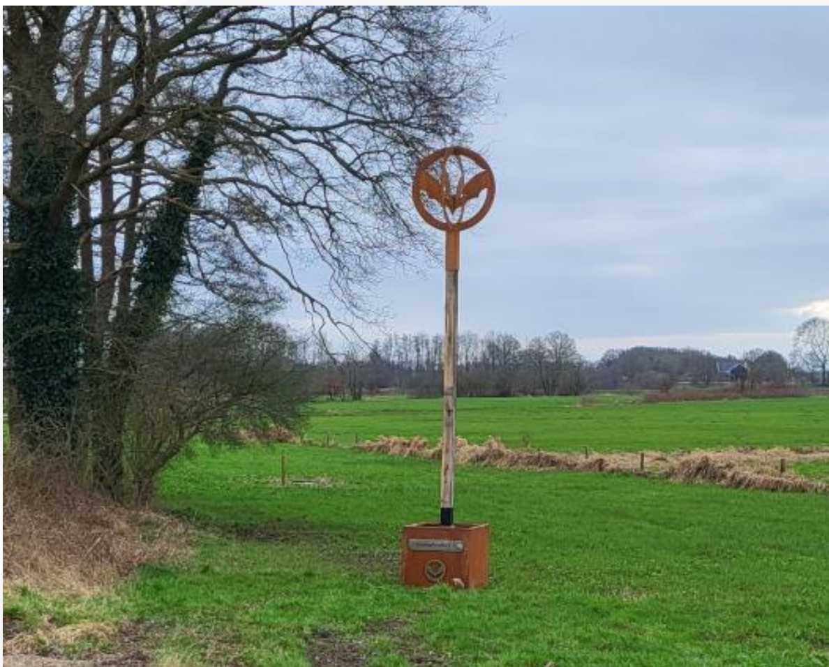
Figuur 9. Vleermuisbaken op paal in verplaatsbare bak, met op foto het type FaunaFlex. Bron: Fauna Protect.
