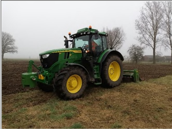
Frezen toplaag maaiveld
