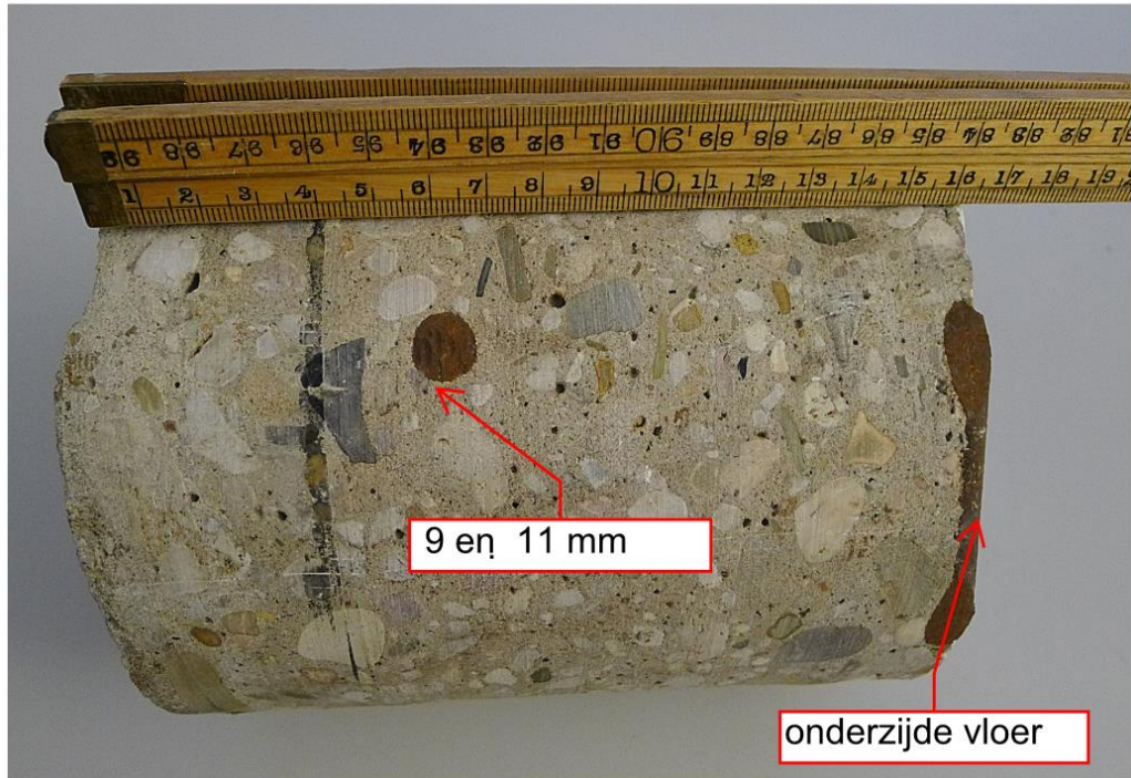
Foto 5: Boorkern verdiepingsvloer gebouw 45
