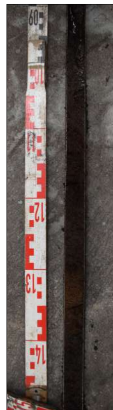
Afbeelding 12. Gutsboor met de inhoud van boring 25 van 100 tot 145 cm -mv. Hier is de bruinigrijze kleilaag te zien met het veenlaagje ertussen.
