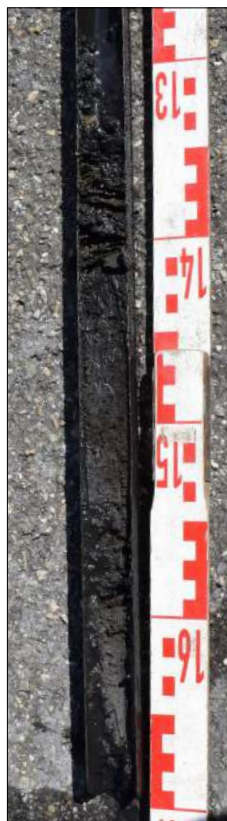
Afbeelding 9. Gutsboor met de inhoud van boring 15 van 130 tot 160 cm -mv. Hier is de overgang te zien tussen een veraard veenlaagje (mogelijk oppervlak) en een kleilaag.
