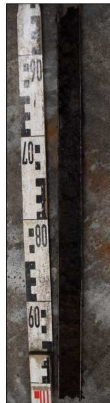
Afbeelding 11. Gutsboor met de inhoud van boring 25 van 50 tot 100 cm -mv. Hier is de onge-roerde veenlaag te zien.
