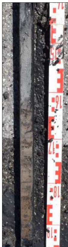
Afbeelding 10. Gutsboor met de inhoud van boring 15 van 150 tot 195 cm -mv. Hier is de overgang te zien tussen een kleilaag, een zandlaag en twee venige lagen.
