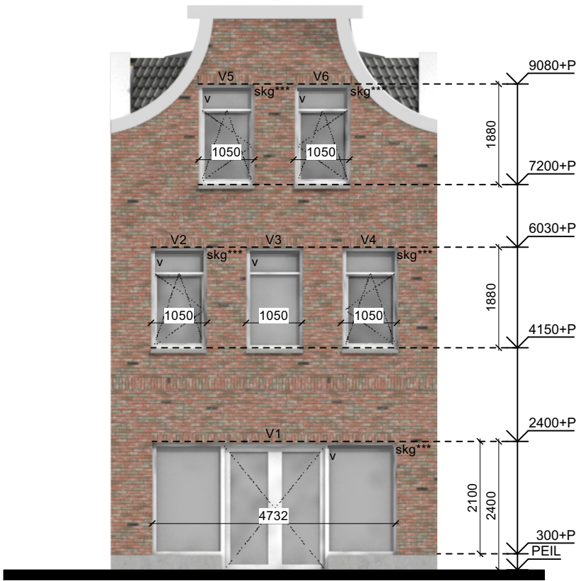
Voorstraat 26 v = ventilatierooster DucoLine 23ZR
