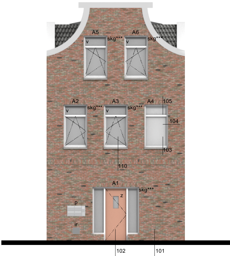
Wilhelminaplein 11 v = ventilatierooster DucoLine 23ZR p = 4x postkast en spreekinstallatie met camara in verbinding met 4 appartementen z = zelfsluitende deur die van buitenaf niet zonder sleutel kan worden geopend ir = inbouw muurrooster DucoGrille G70V - verticaal
