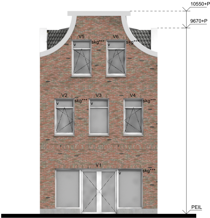
Voorstraat 26 v = ventilatierooster DucoLine 23ZR
