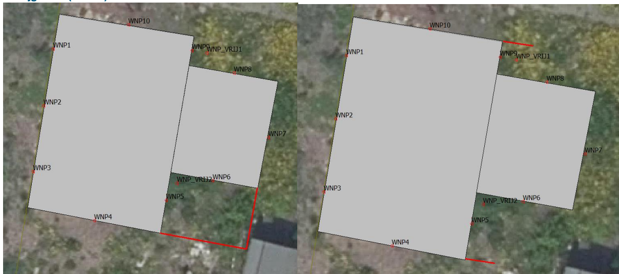
Figuur 5.1: Maatregelen in de vorm van een scherm van 2 tot 2,5 meter hoog (links) en akoestisch oren in het verlengde van de zijgevels (rechts).
