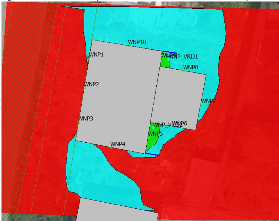
Figuur 5.2d: Geluidcontouren op 4,5 meter met akoestische oren van 2 meter diep en 5 meter hoogte.
