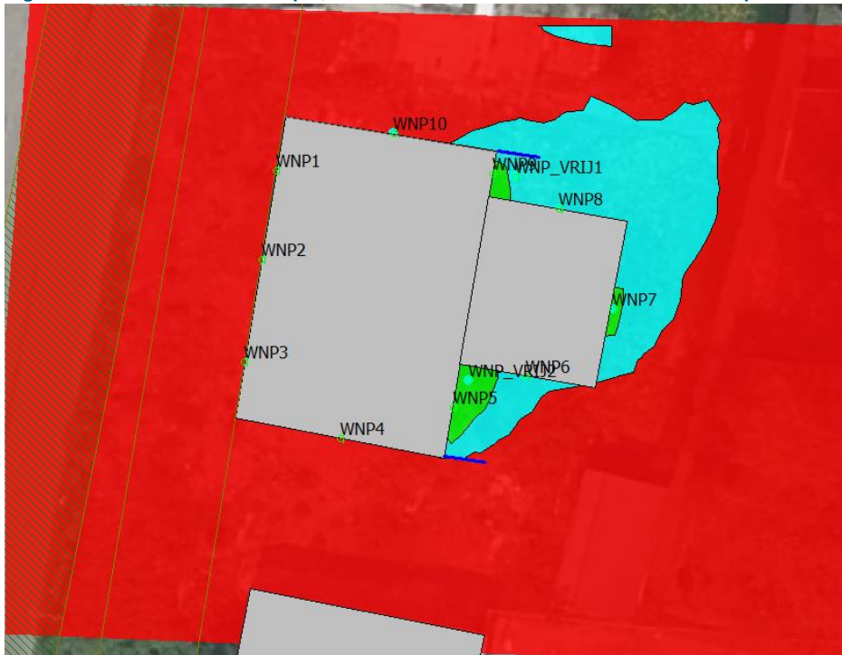
Figuur 5.2d: Geluidcontouren op 4,5 meter met akoestische oren van 2 meter diep en 5 meter hoogte.
