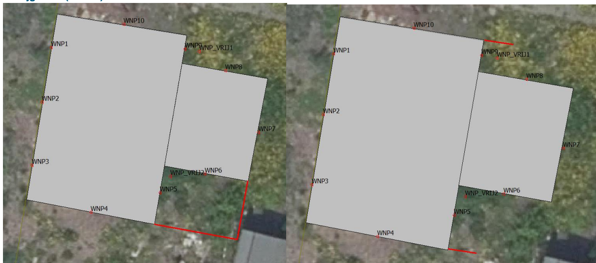
Figuur S2: Maatregelen in de vorm van een scherm van 2 tot 2,5 meter hoog (links) en akoestisch oren in het verlengde van de zijgevels (rechts).
