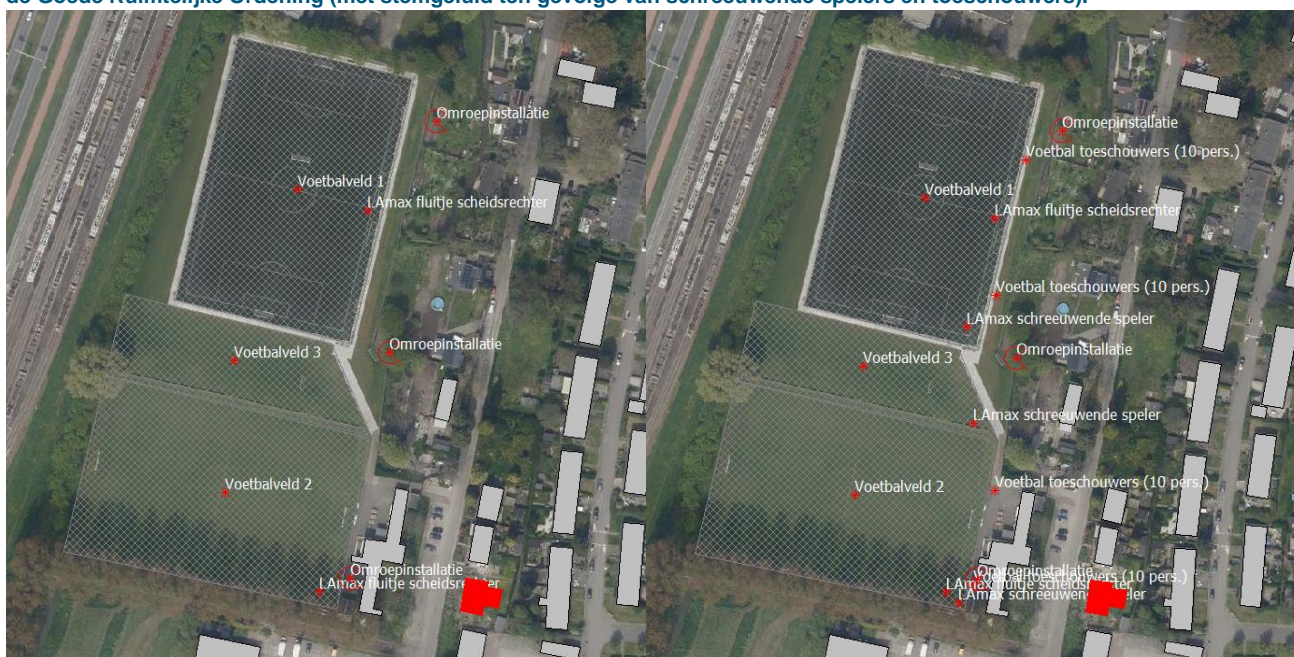
Figuur 3.3: Rekenmodel met de bronnen (links het model voor het Activiteitenbesluit en rechts het model in het kader van de Goede Ruimtelijke Ordening (met stemgeluid ten gevolge van schreeuwende spelers en toeschouwers)).
