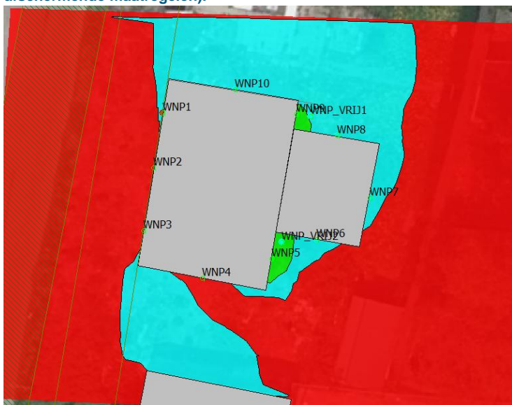
Figuur 5.2b: Geluidcontouren met scherm van 2,5 meter hoogte.
