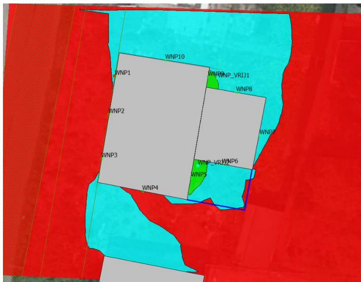
Figuur 5.2b: Geluidcontouren met scherm van 2,5 meter hoogte.
