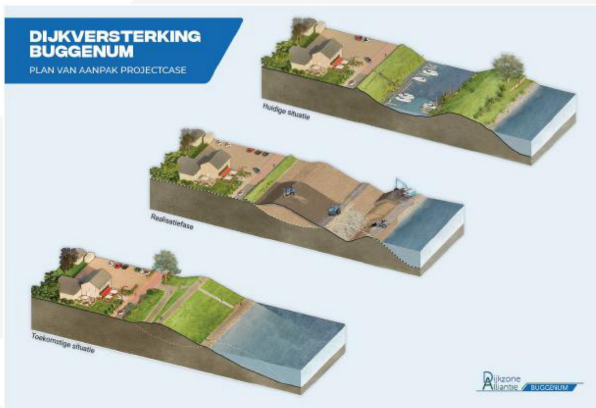
Figuur 6. Visualisatie van het profiel van de watergang en dijk in de huidige situatie, realisatiefase en toekomstige situatie (bron: Dijkzone Alliantie).
