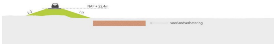
Figuur 3.3 Indicatieve dwarsdoorsnede dijkvak 3 en 4 (VKA 3A)
