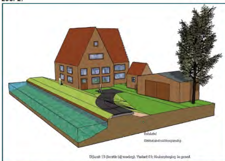
Figuur 5-35: Principeschets kansrijke alternatief 15.1 "Kruinophoging in grond"
