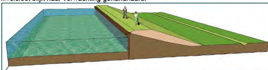
Figuur 5-9: Principeschets kansrijk alternatief 2.3 "Waterkerende constructie i.c.m. dijkverlegging"
