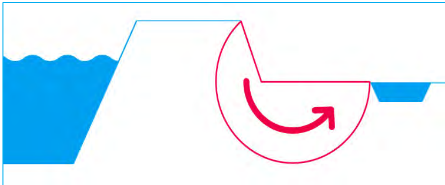
Figuur 6 Afschuiven van de dijk door stabiliteitsverlies
