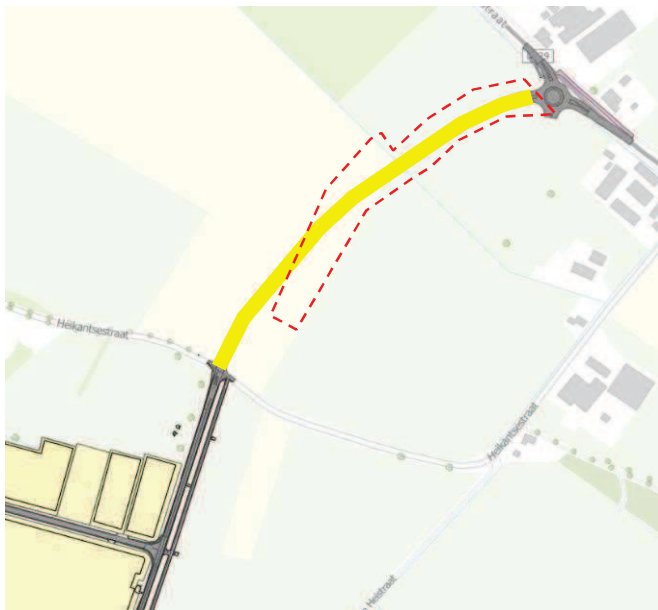
Figuur 8: Gedeelte van de ontsluitingsweg (gele lijn) wat in stil wegdek met asfalttype SMA NL8G+ wordt uitgevoerd
