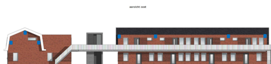
figuur 5.4 Locaties van de te realiseren stootvoegen (blauw).
