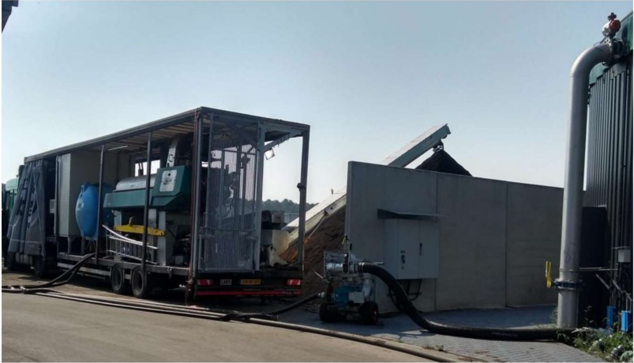
Figuur 2 Voorbeeld mobiele scheider op een andere locatie
