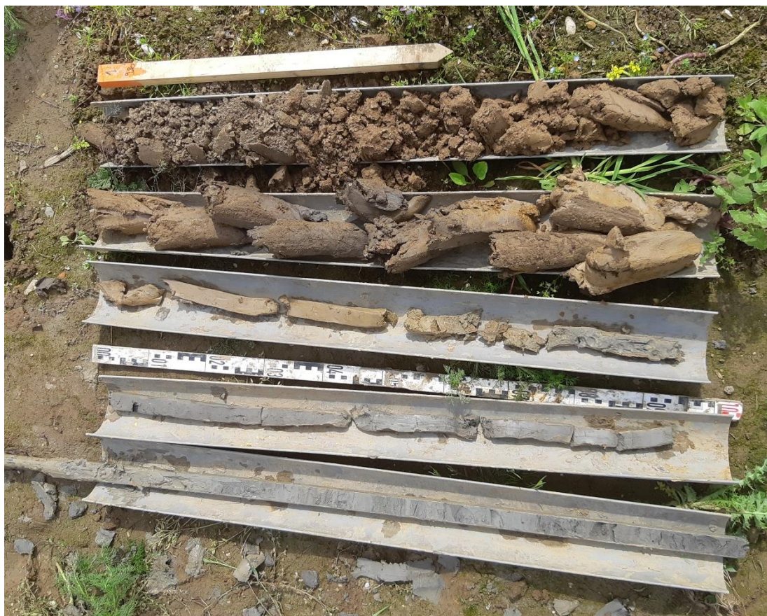
Afbeelding 14: Foto van het boorprofiel van Boring 1 met van boven naar onder en v.l.n.r. achtereenvolgens de bouwvoor, de oeverafzettingen, komafzettingen, oeverafzettingen met een cultuurlaag, kronkelwaardafzettingen. De boring is gestuit in grof grindrijk zand van de Formatie van Kreftenheye.
