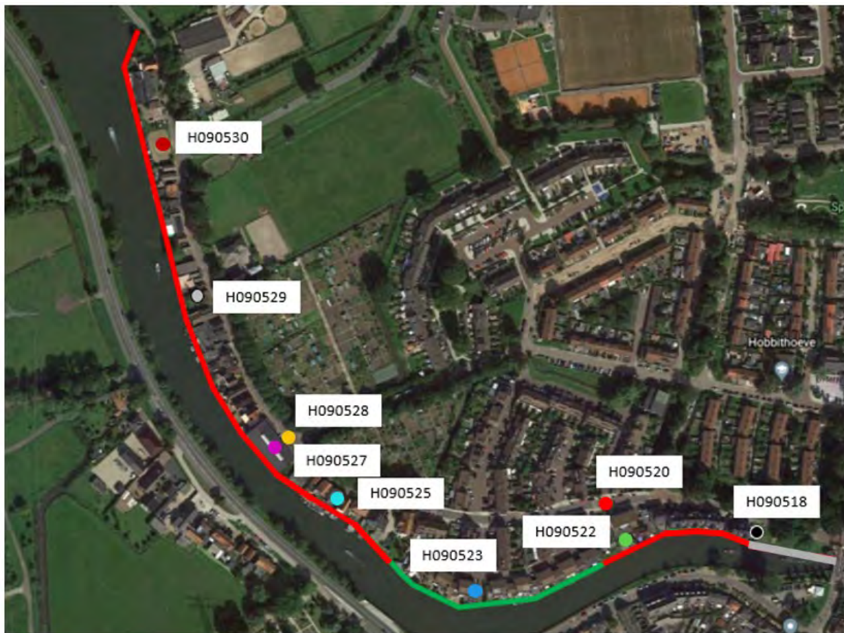
Figuur 13 – Overzicht voorlopige beoordeling verticale constructie (groen = geen vervanging, rood = vervanging, grijs = buiten de scope). Ook de locaties van de voor dit onderzoek geplaatste freatische peilbuizen zijn weergegeven.
