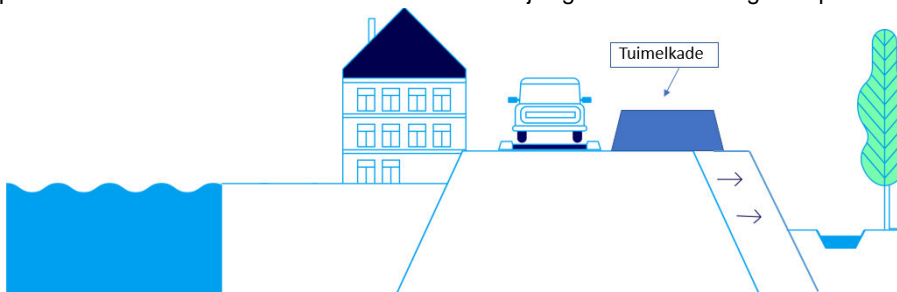
Figuur 37. Principeschets tuimelkade optie B
