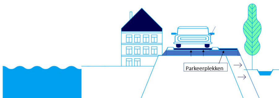
Figuur 21. Principeschets verbreden dijk, opschuiven as
