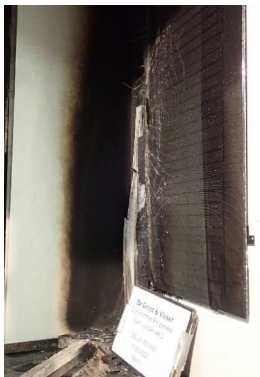
Fotog 3 and 4: Proefstuk, na de test
