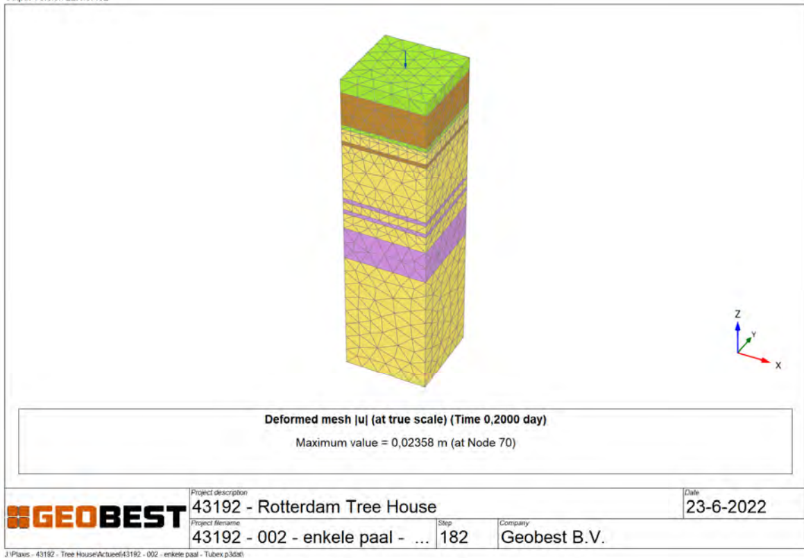
Figuur 9.3: Plaxis 3D model met enkele Tubex paal 762/950 mm
