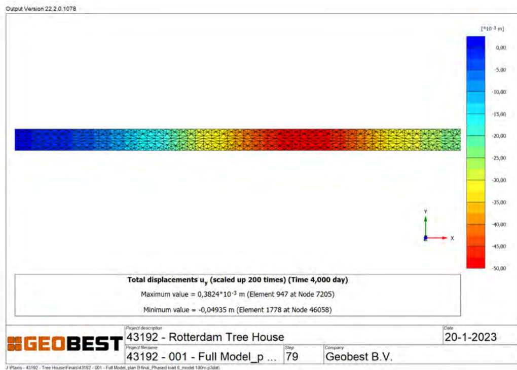
Figuur 12.2: Horizontale verplaatsing plintgebouw na ontgraven bouwput
