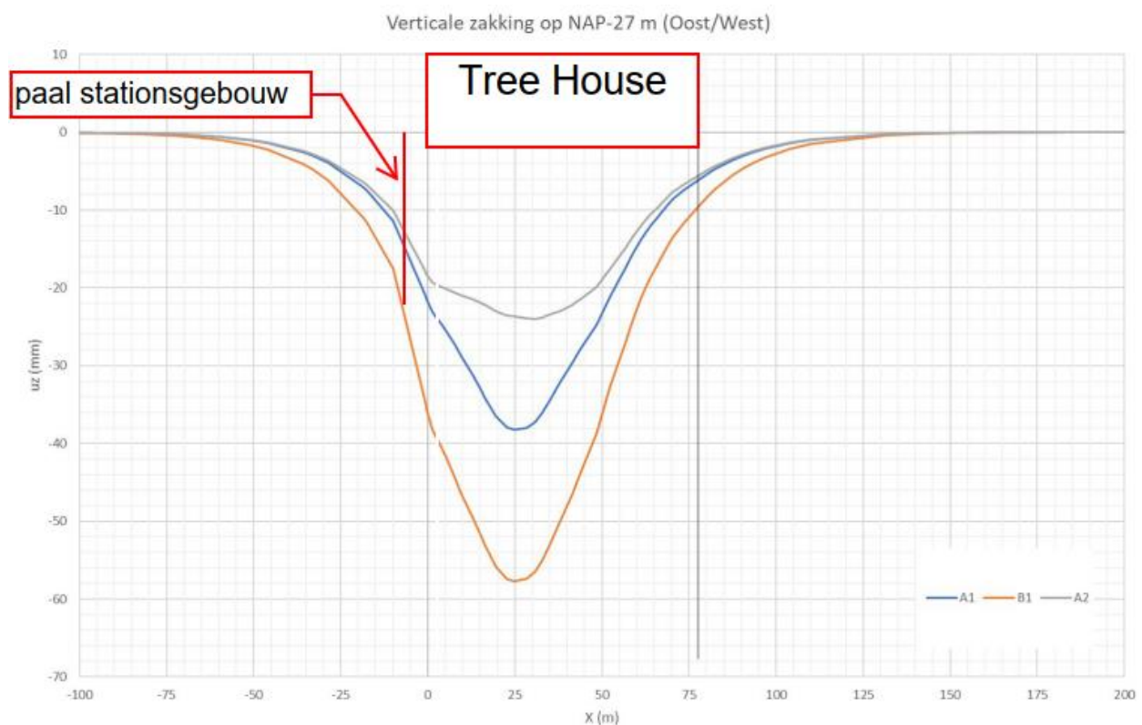
Figuur 3-1: Verticale zakking op NAP – 27.
