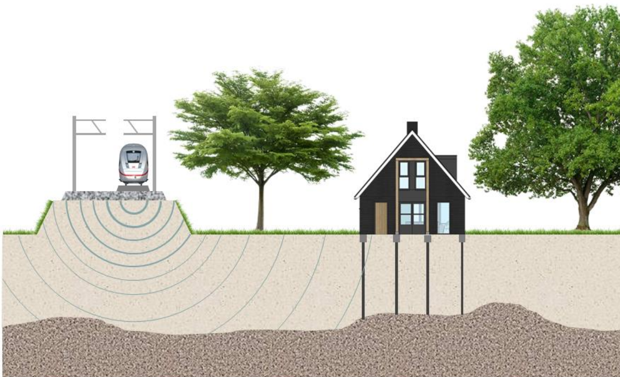
Figuur 6 Trillingen –system van trillingsbron, bodem als doorgeefmedium en gebouw als ontvanger
