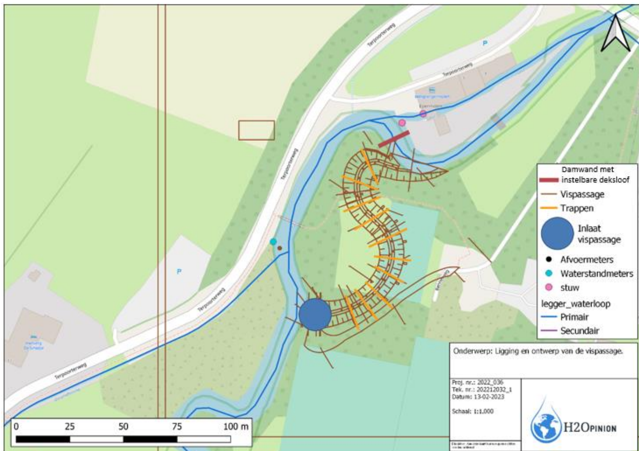
Figuur 12: Locatie en inrichting van de vispassage en damwand met instelbare deksloof te Wingbergmolen.
