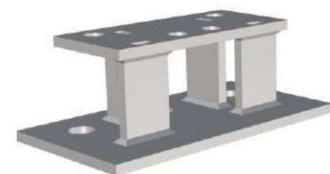
figuur: principe funderingstuk 'halve taart' (t.b.v. 2 kolommen)
