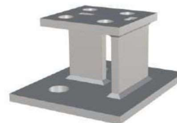
figuur: principe funderingstuk 'kwart taart' (t.b.v. 1 kolom)
