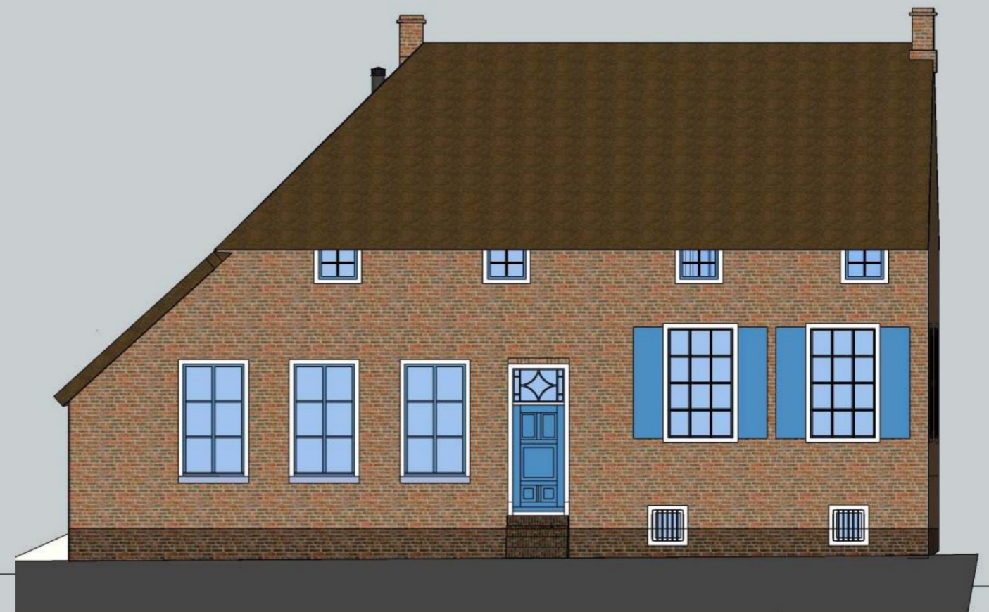
noordgevel nieuw met toegevoegd kelderraam ( oorspronkelijk ook een opening aanwezig geweest )
