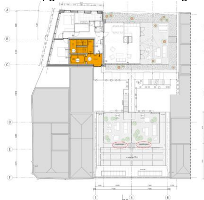
Figuur 6 condensors op het dakterras boven de 3 e verdieping
