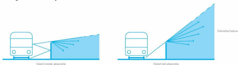
Figuur 3: Geluidsreflectie met en zonder absorptie (bron: Akoestiekwinkel.nl)
