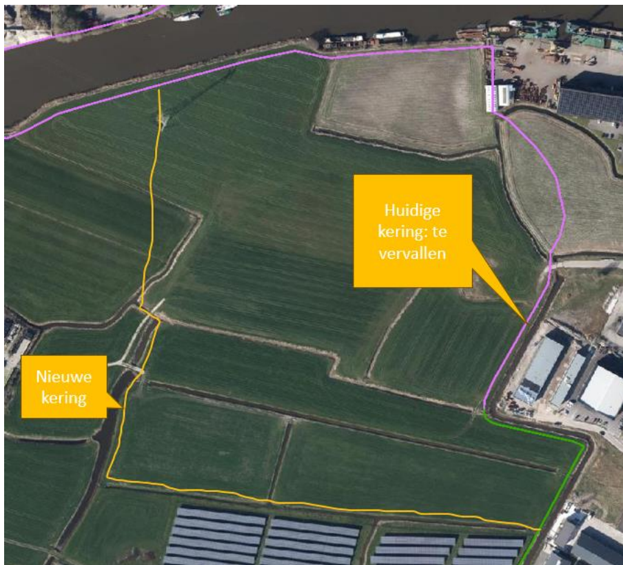
Figuur 5: verlegging kering t.b.v. peilwijziging
