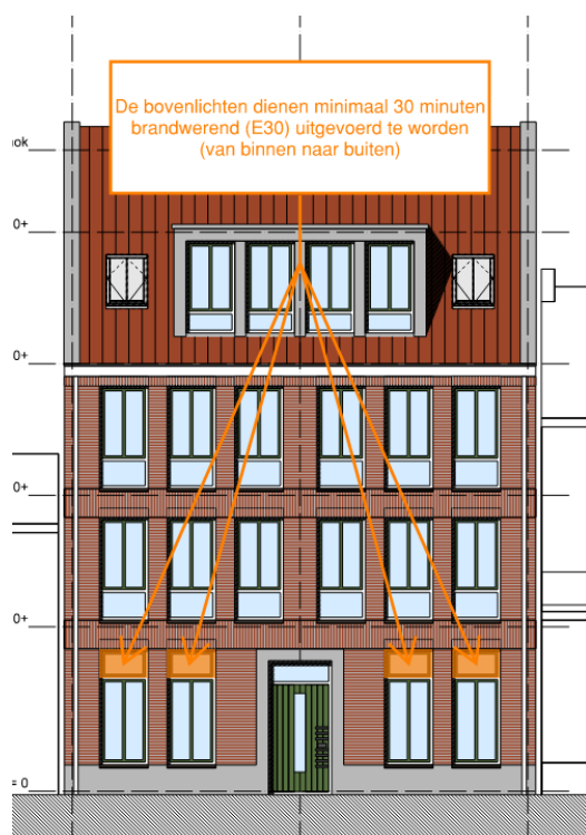
Figuur 3, overzicht brandwerende maatregelen voorgevel
