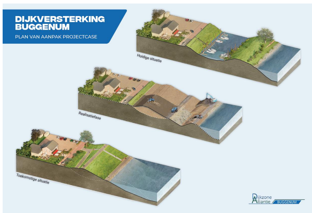
Figuur 3. Visualisatie van het profiel van de watergang en dijk in de huidige situatie, realisatiefase en toekomstige situatie (bron: Dijkzone Alliantie).
