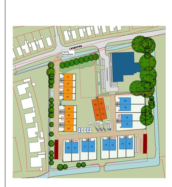
lichtmast bouwaansluiting(stroom) bouwaansluiting(water) bouwlift afvalcontainer schaftkeet zaagloods container schaftkeet installateur container installateur puinbaan tbv. laden, lossen en hijsen parkeren bouw personeel
