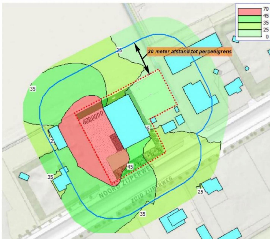
Afbeelding 11: Toetsing aan de 45 dB(A) etmaalwaarde op 30 meter afstand van het terrein (1,5 meter hoogte)
