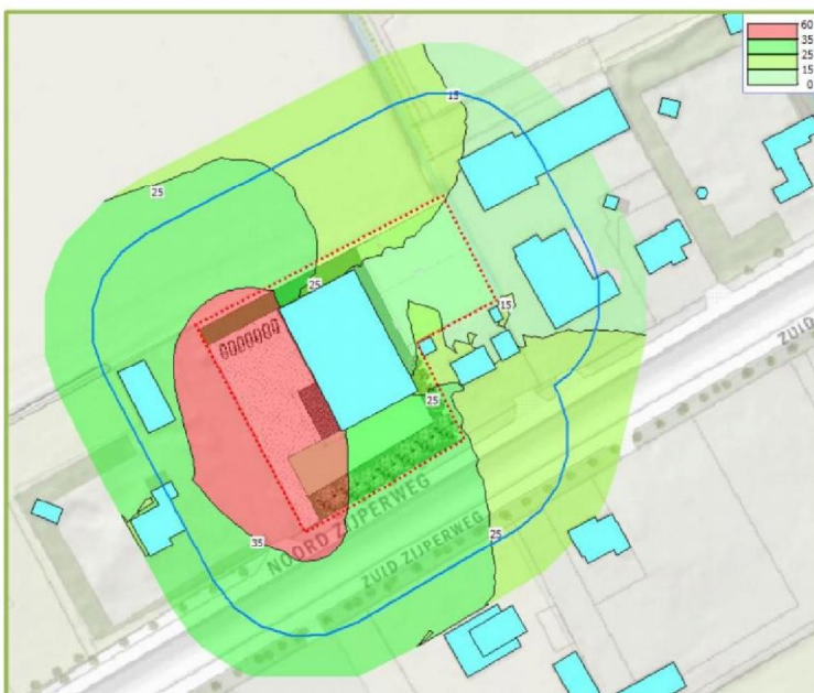
Afbeelding 13: Toetsing aan de 35 dB(A) in de nachtperiode op 30 meter afstand van het terrein (5 meter hoogte)
