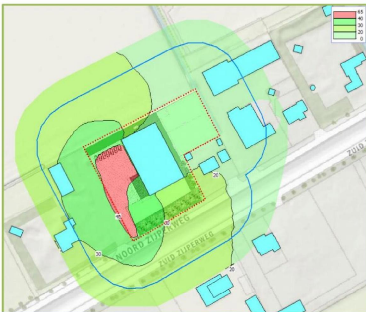
Afbeelding 12: Toetsing aan de 40 dB(A) in de avondperiode op 30 meter afstand van het terrein (5 meter hoogte)
