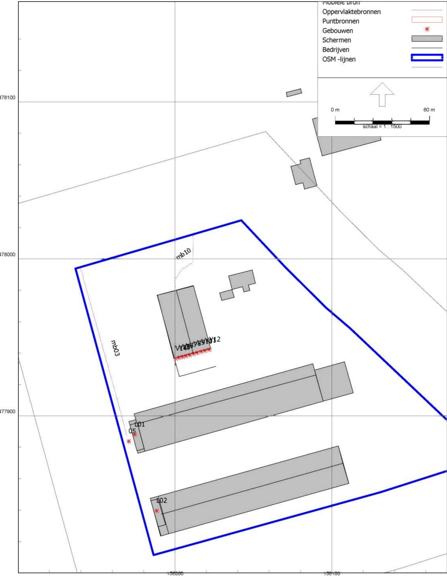
figuur 5a: Overzicht rekenmodel met positie geluidbronnen -aanvoer voer en ventilatoren-
