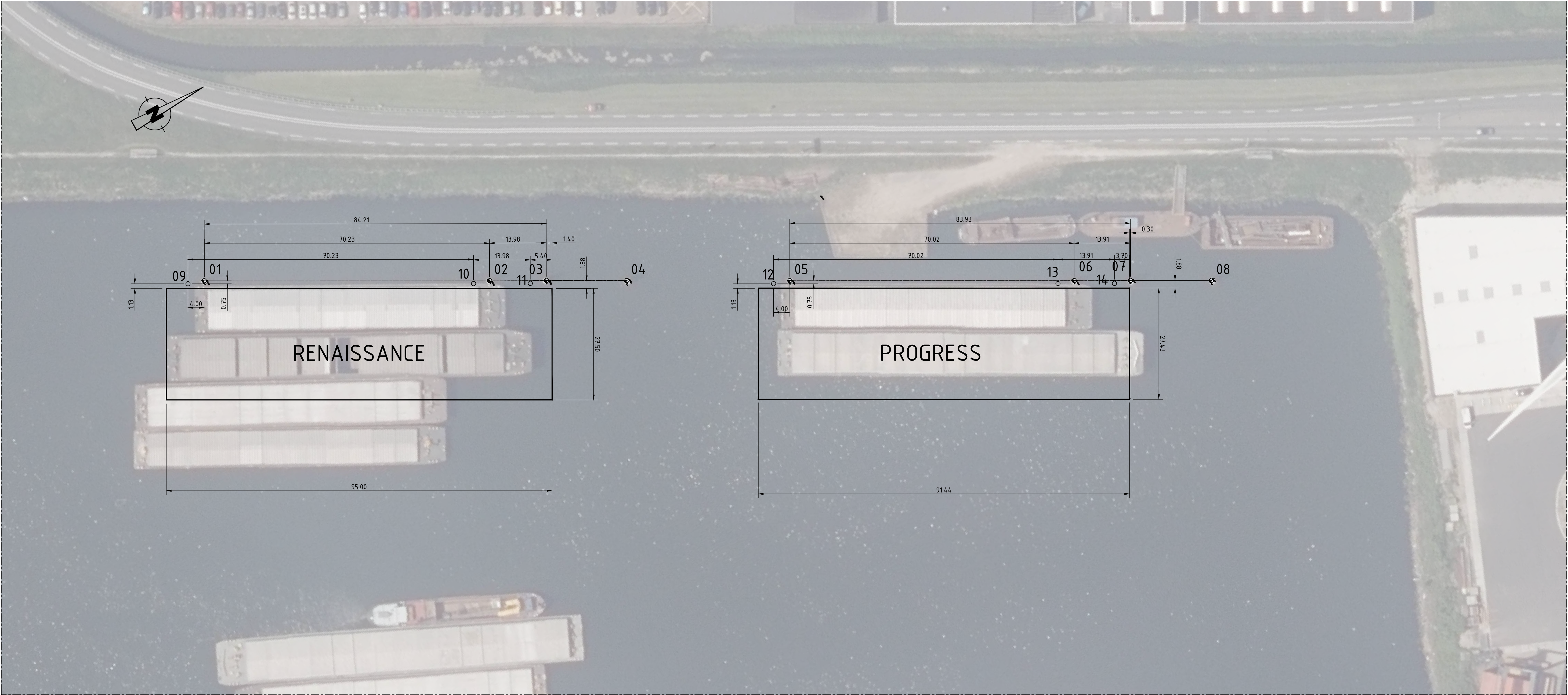
SITUATIE / BOVENAANZICHT: NIEUWE en TE HANDHAVEN MOORINGPALEN t.b.v. SCHEPEN RENAISSANCE en PROGRESS (schaal 1:500)
