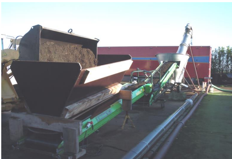
Figuur 7 Installatie voor hygiënisatie van dikke fractie door middel van een vizel met stoominjectie die lost in een oplegger (Foto Livestock Research).
