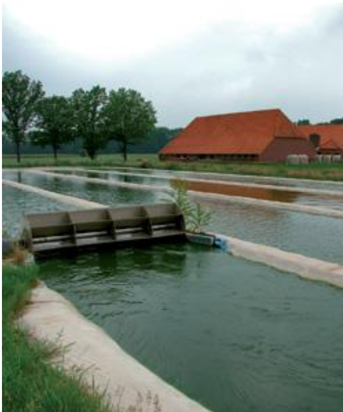
Figuur 12 Open kweekstelsel voor algen, een zogenaamde 'raceway pond' met roerwerk.
