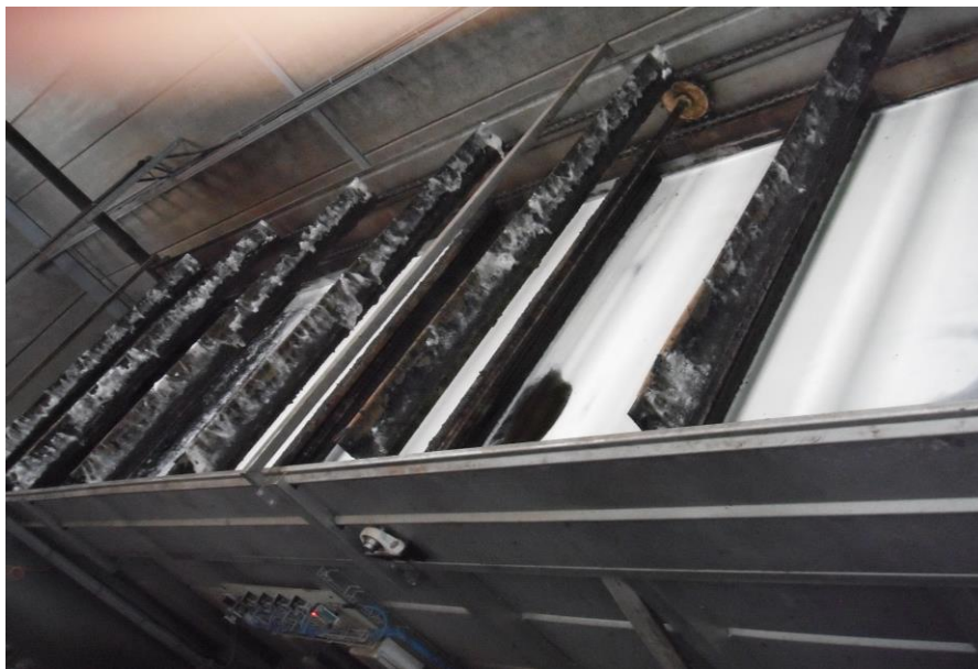
Figuur 4 Flotatietank voor dunne mest waar de gevormde drijf laag ('schuim') van de vloeistof wordt afgeschraapt.
