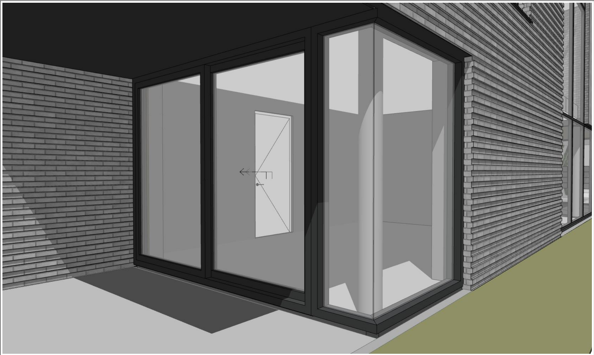
3. Kozijn voorzien van koud-beglaasde hoekverbinding
