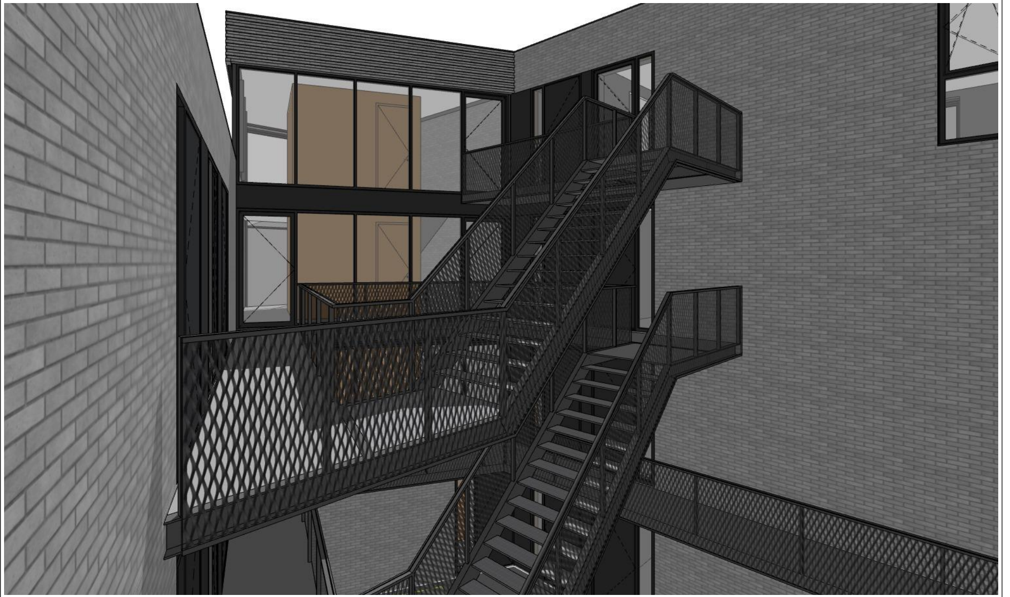
5. Stalen trap tussen betongallerij, stalen C-profiel doorzetten voor betongallerij langs.
