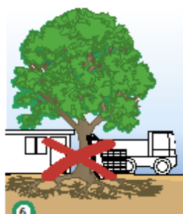
6 Plaats geen bouwmaterialen of bouwketen en parkeer geen voertuigen onder de kruin van de boom. De grond raakt hierdoor verdicht waardoor boomwortels afsterven.
