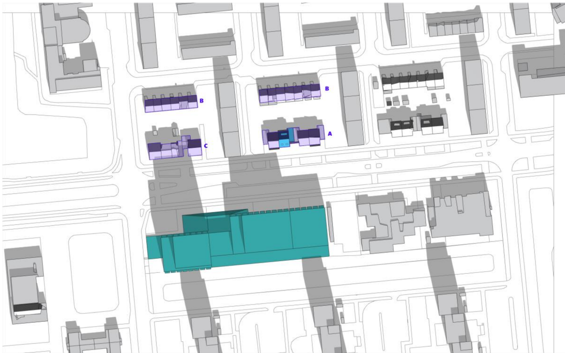
Afbeelding 4.1 Uitgelicht bezonningsdiagram, met aanwijzingen, 21 maart, 12.00 uur. nieuwe situatie
