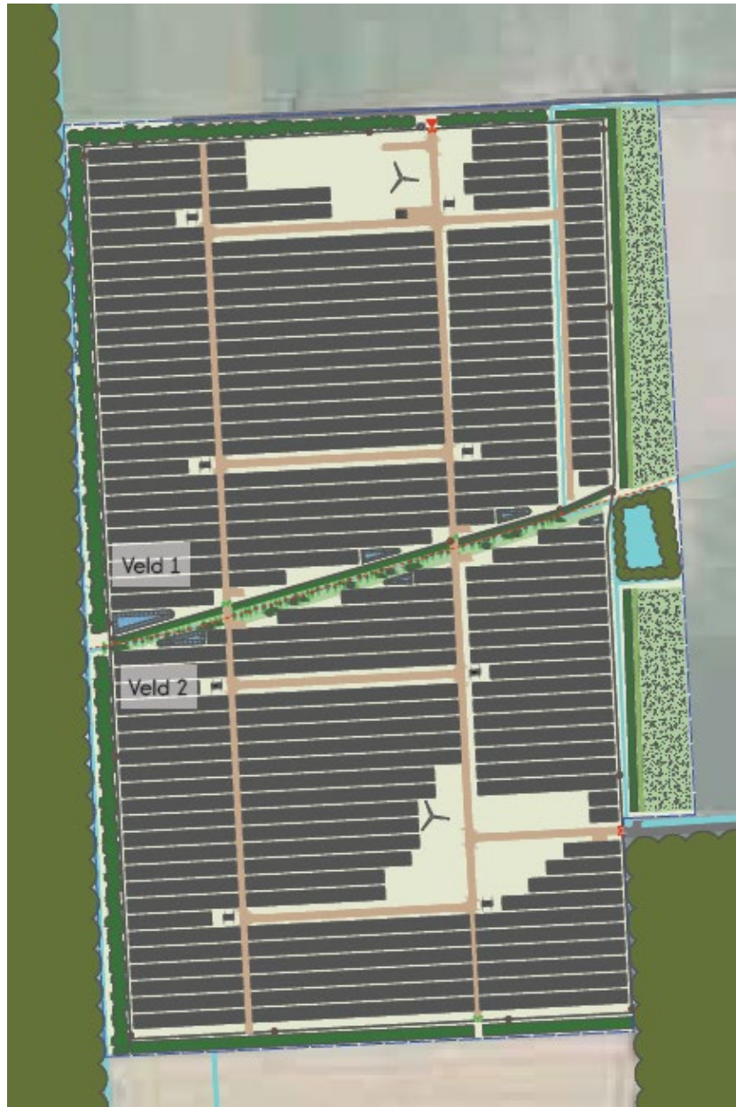
FIGUUR 8: UITSNEDE LANDSCAPPELIJK ONTWERP ZONNEPARK LAARAKKERDIJK, VELD 1 EN VELD 2 WORDEN GESCHIEDEN DOOR AANWEZIGE WATERGANG 'KLOTGOOR', VOOR VERGROTE VERSIE MET LEGENDA ZIE BIJLAGE A: LANDSCAPPELIJK ONTWERP BRON: LABELTIEN
