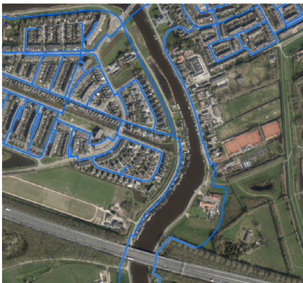
Figuur 4: Locatie van de drinkwaterleiding in de dijk
