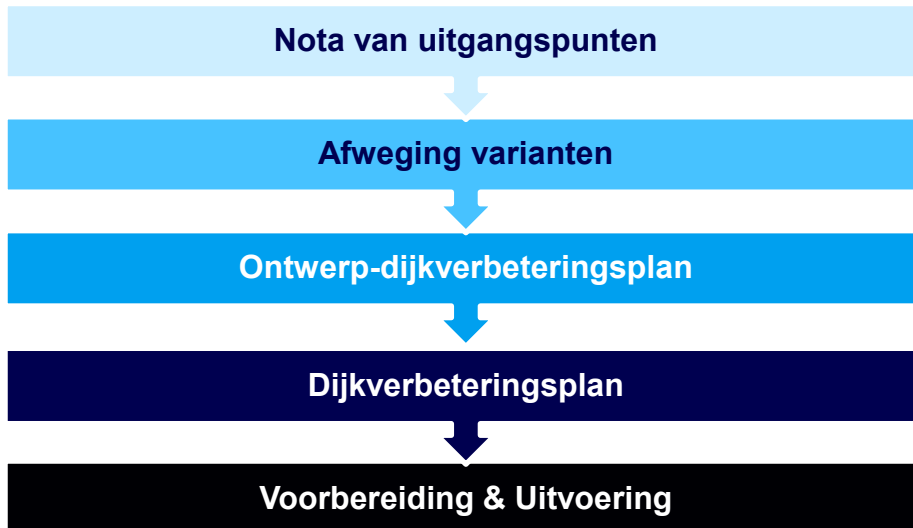
Figuur 3-1 Proces dijkverbetering Rondehoep Oost
