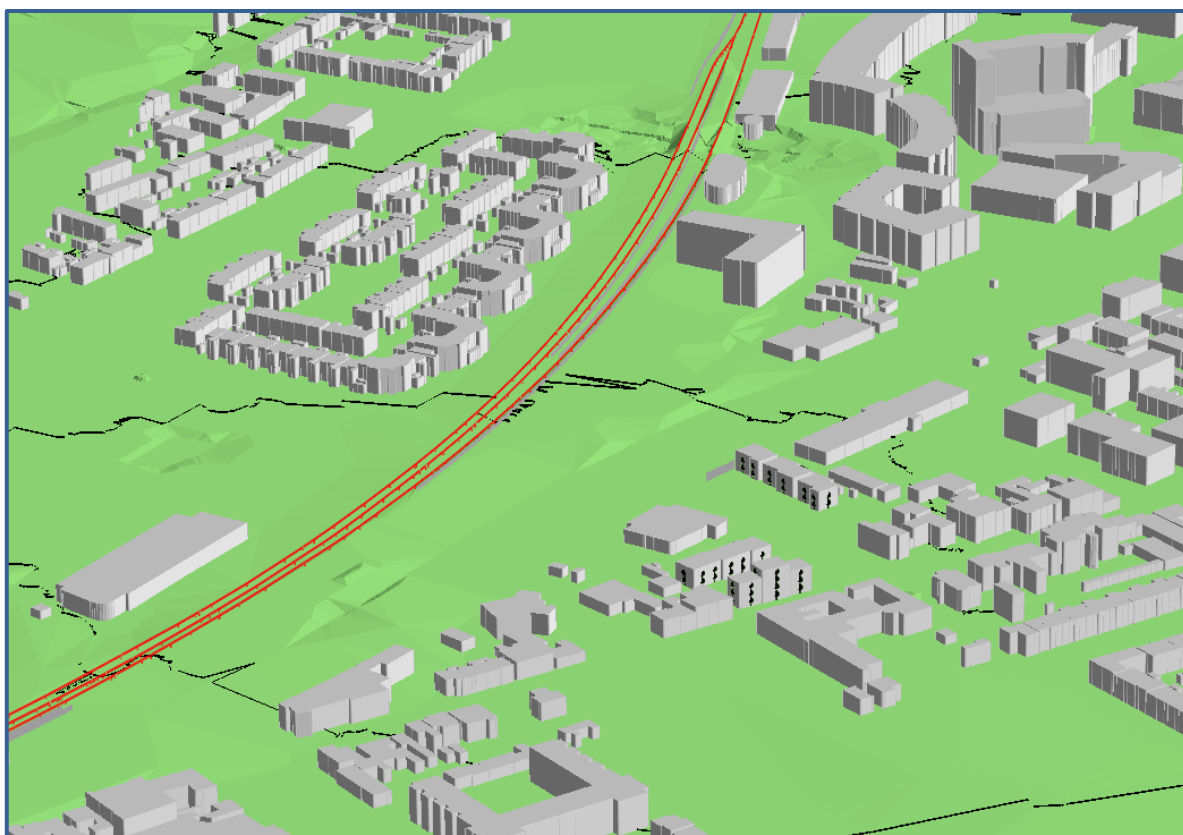
Afbeelding 4. Rekenmodel, 3d-weergave met spoorwegen
