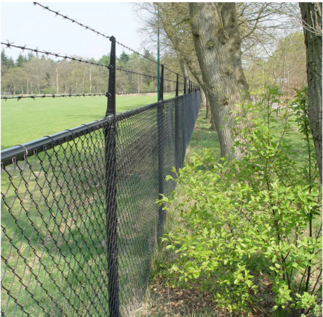
Hekwerk hoogte 1,5 meter: gazen hekwerk 1 meter excl. 3 puntdraden staanders 1730 mm, kleur zwart, gecoat, incl. grondverankeringsplaat rechte puntdraadhouder, kleur zwart, gecoat (Heras)
