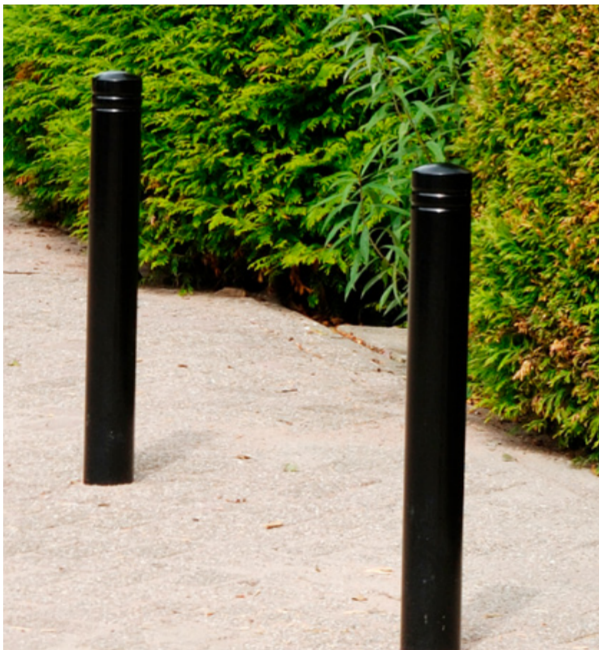
Afnembare paal: diameter 100 mm, verzinkt en gecoat, kleur zwart, zonder reflectiebanden, met betonvoet (Velopa)
