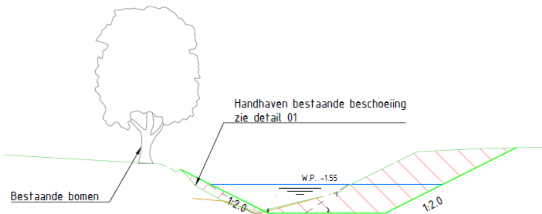
Figuur 7: Eenzijdige verbreding watergang B
