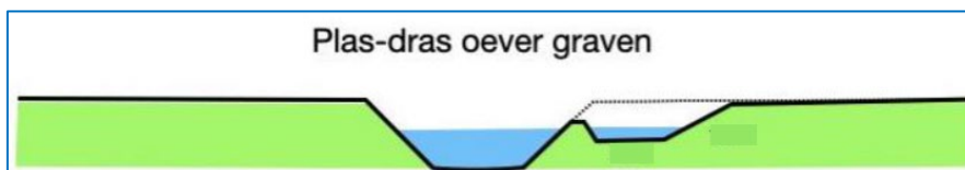
Figuur 50. Schetsmatige doorsnede watergang en natuurvriendelijke oever.
