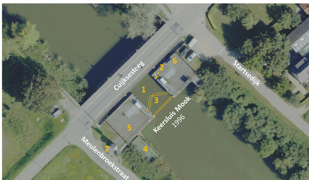
Figuur 2-2: Situatieschets rondom de keersluis: 1) sluiskolk, 2) sluiswanden, 3) puntdeuren, 4) opslag schotbalken, 5) sluisplateau / kistdam 6) bedieningskast, 7) voormalige heftoren / uitzichtpunt
