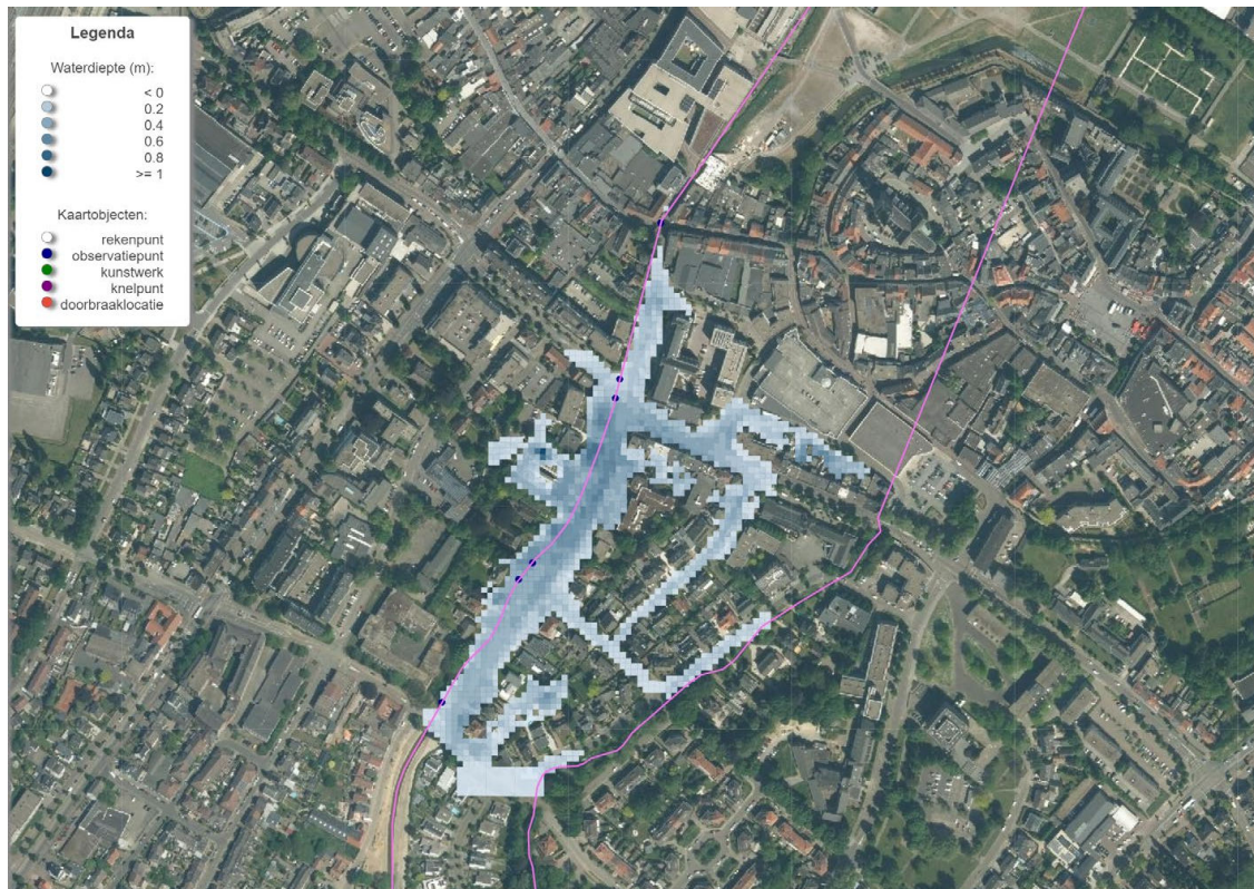
Figuur 25 Overstromingsbereik in het definitief ontwerp, bij een afvoer van 48 m 3 /s.
