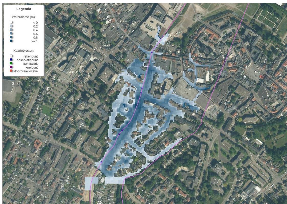
Figuur 24 Overstromingsbereik in de referentiesituatie, bij een afvoer van 48 m 3 /s.
