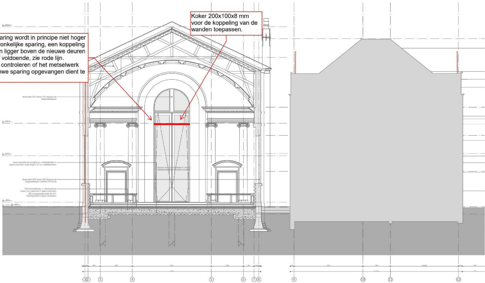
NIEUWE SITUATIE DOORSNEDE A schaal 1:100
