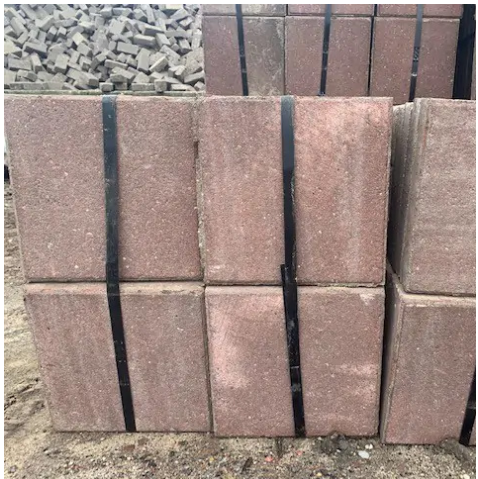
terreinafwerking privé terrassen Schoterbosstraat hergebruikte betontegels/ klinkers
