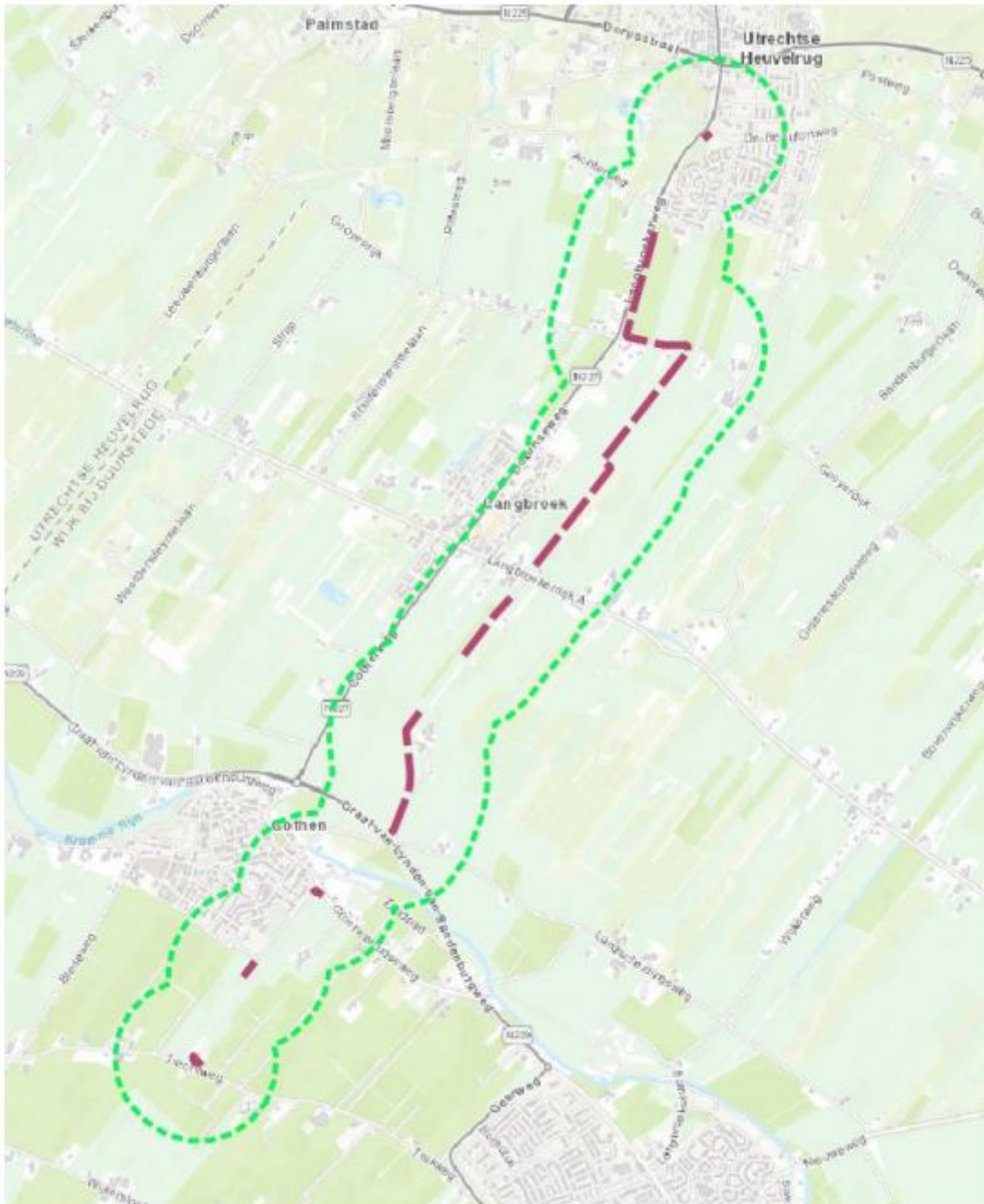
Figuur 2.1 Verlagingscontouren (0,05 m invloed) bemaling beneden GHG/GHS
