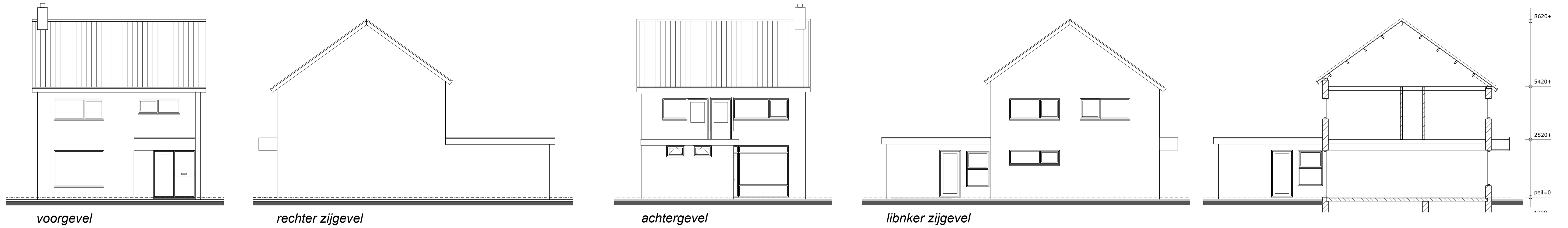
bestaande situatie - gevels uitgevoerd in metselwerk
