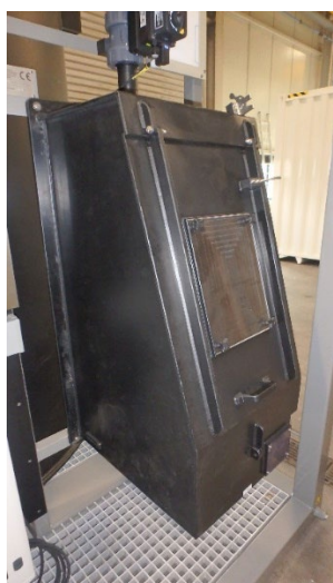
Foto 1 en 2; vulkast met afsluitbare kap, vulleiding met AKZO koppeling
